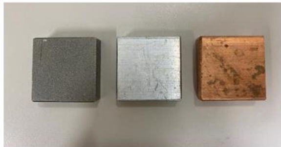
図 7 3 種のブリネル試験片
